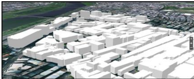
圖 1. LoD1-S 模型示意圖
