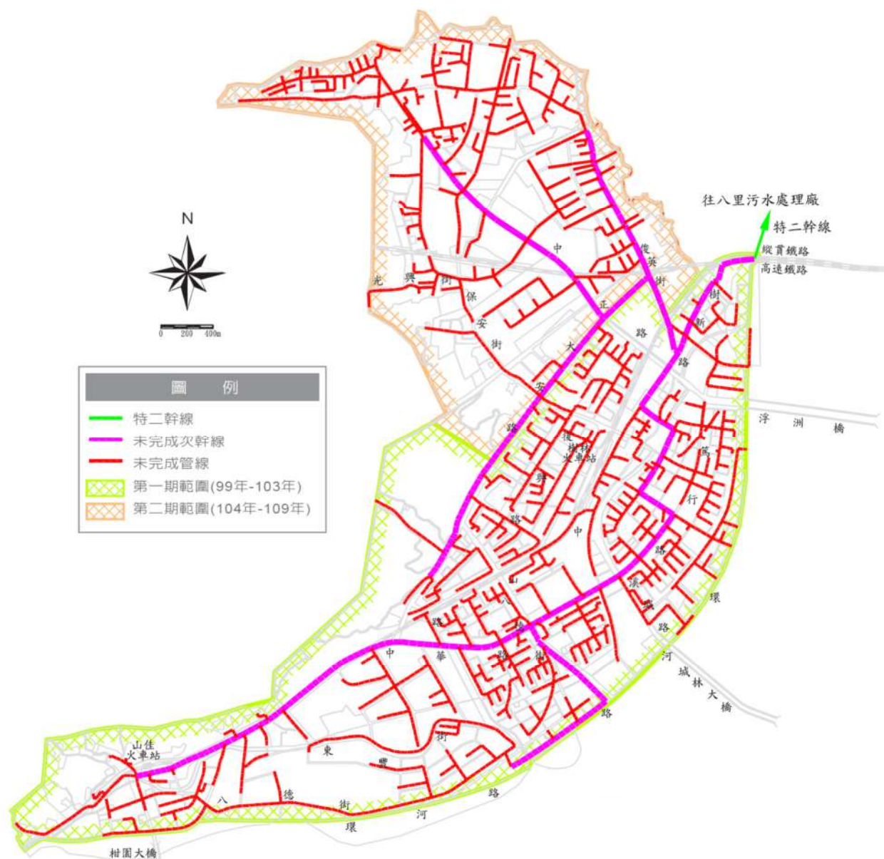
圖 4.6-1 樹林地區污水下水道系統建設圖
